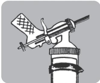
**1** Retirer la bombe mousse du pistolet et ôter la mousse restante dans l'adaptateur.
