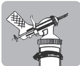
**2** Visser la bombe de nettoyage dans l'adaptateur. Vérifier que la bombe est en position verticale dans le sens visualisé.
